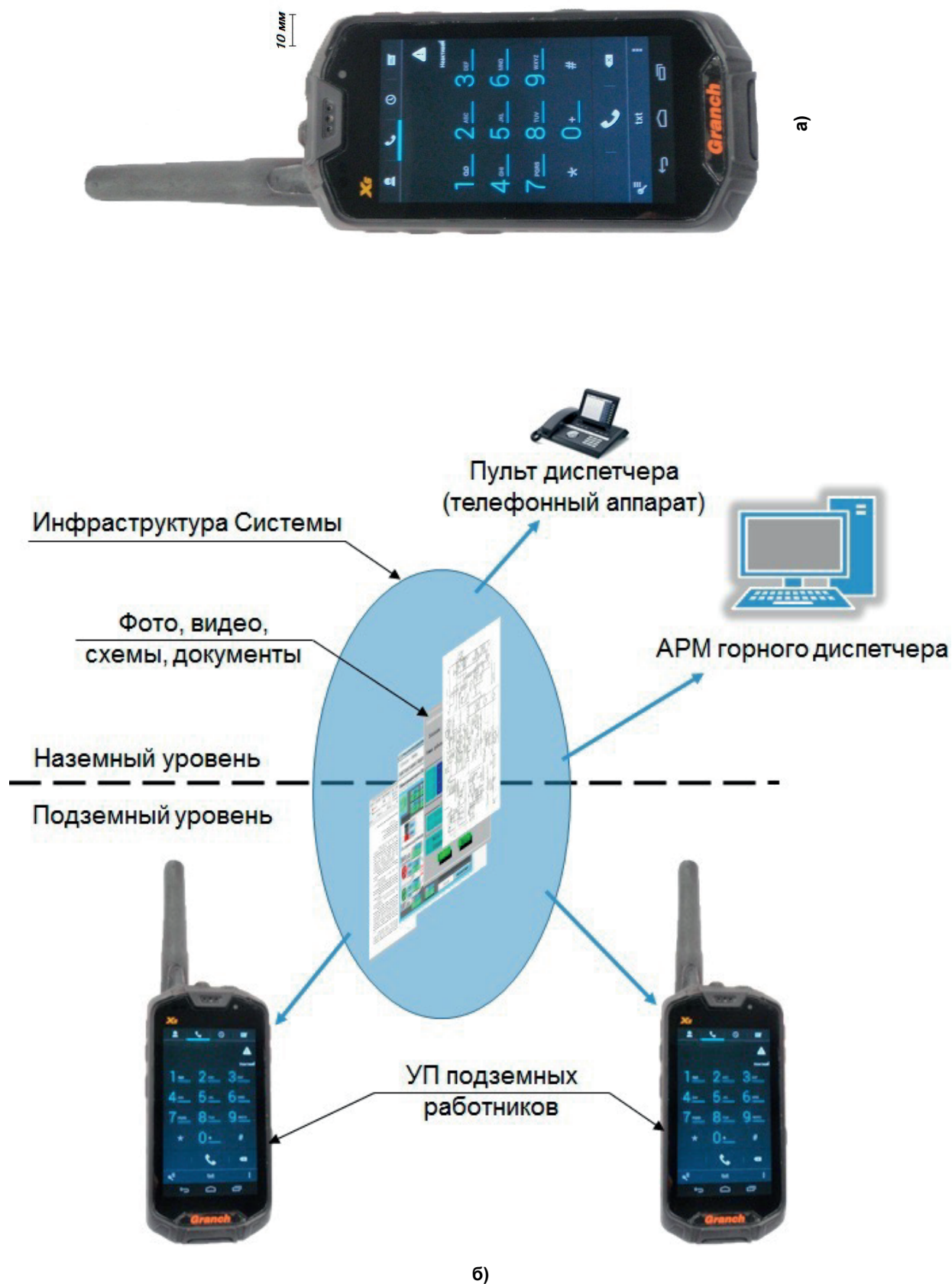
Рисунок 5 – Устройство переговорное: а) вид общий; б) мобильная связь между устройствами переговорными и с АРМ (пульт) диспетчера
