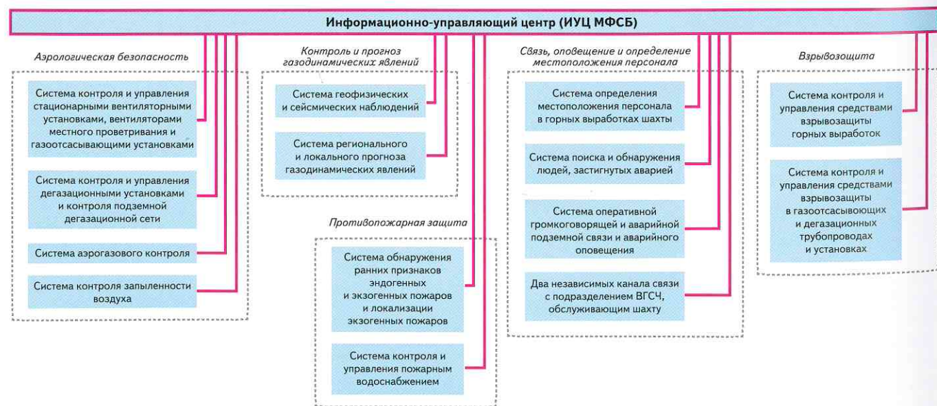
Рис. 1 Структурная схема многофункциональной системы безопасности (МФСБ) шахты
